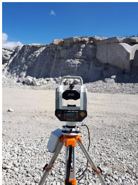
Fig. 62 – Levantamento topográfico com perfilómetro laser
